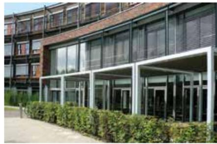
Eine Schräge für alle Fälle: Die Dachmarkise lässt sich absenken, so dass Regenwasser einfach ablaufen kann. Die vertikale Markise eignet sich auch hervorragend zur Beschriftung.
